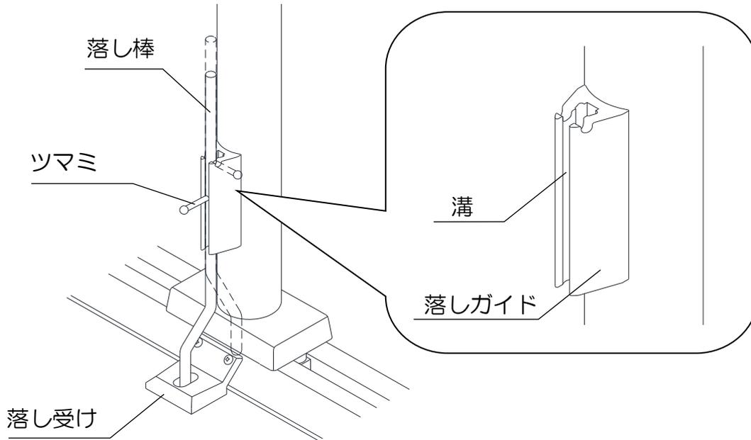
■ 落とし棒を上げるときはつまみを持って、落としガイドの溝につまみを通し、落としガイドの引っ掛け溝に、つまみを掛けてください。
